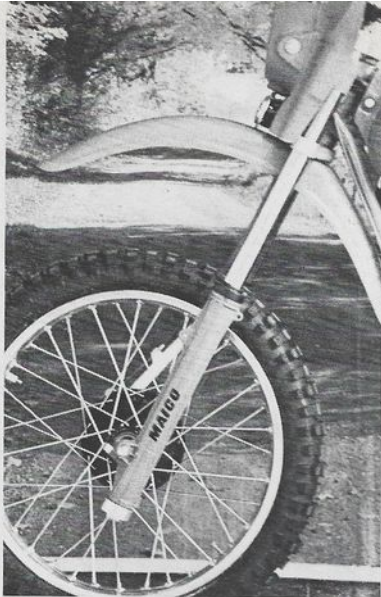
La grande fourche de 250 mm de débattement est amortie par ressorts, huile et air. Dommage qu'il n'y ait pas de soufflets.
