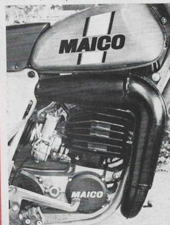
Le réservoir en alu contient 11 litres de mélange. Le carburateur ne possède pas de starter mais un titillateur.
